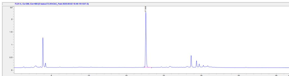
Ilustración 12: Cromatograma de fluorescencia de las muestras de los bolígrafos de tinta fluida enviados desde Alemania, Bélgica y Ecuador
