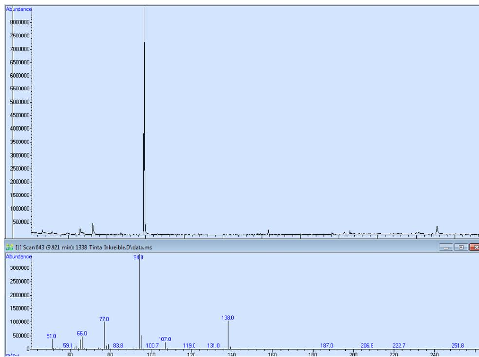
Ilustración 15: Cromatograma GC-MS de las muestras de los bolígrafos de tinta fluida enviados desde Alemania, Bélgica y Ecuador
